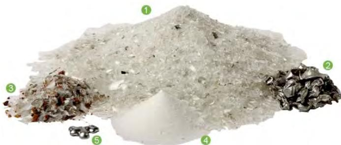
Le recyclage des ampoules fluocompactes et LED s'effectue par **broyage et découpage**. Les produits sont réutilisés, brûlés (= énergie) ou neutralisés lorsqu'ils sont polluants :
